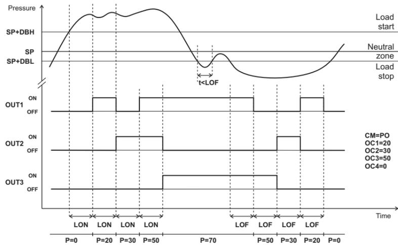
Fig.4 Controllo con ottimizzazione della potenza disponibile
